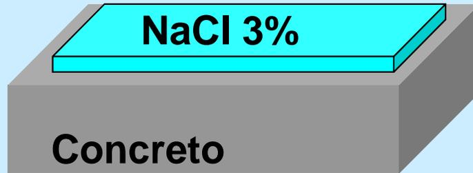
Se mantiene la solución durante 90 días. Luego se extraen testigos, se cortan en rodajas y se determina el contenido de cloruros en función de la profundidad.
